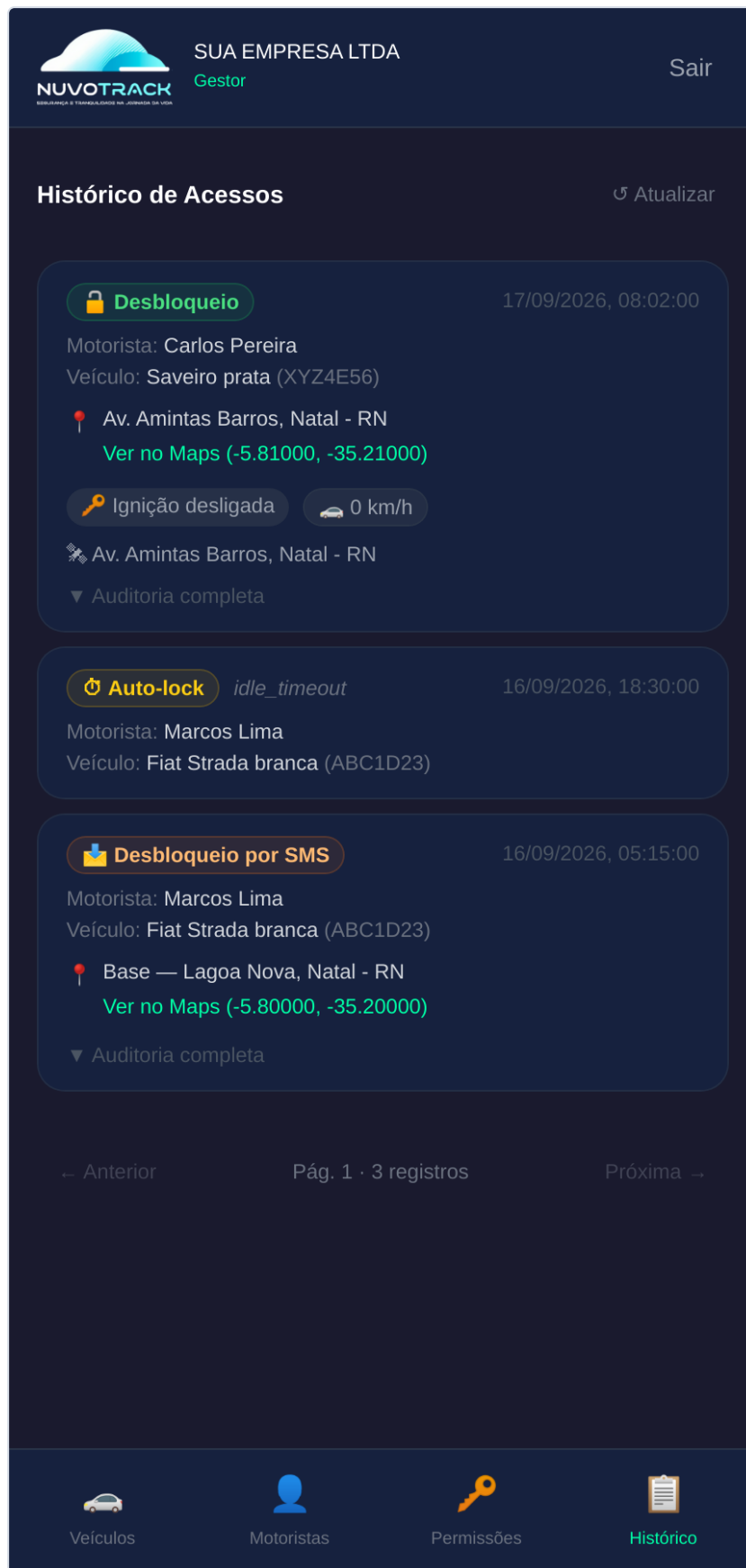
Figura 7. Aba Histórico: desbloqueio, auto-lock e desbloqueio por SMS, com endereço, motorista e veículo.
